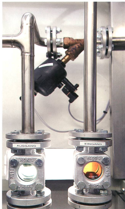
Durch das Verfahren werden die Öle auf das Niveau von frischen Ölen gebracht.
