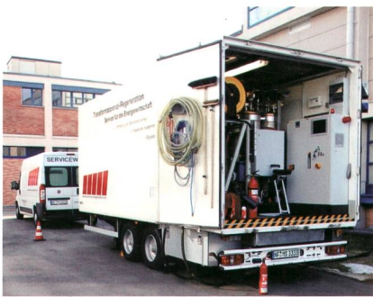
Die mobile Transformatorenöl-Regenerationsanlage inklusive Online-Monitoring.
