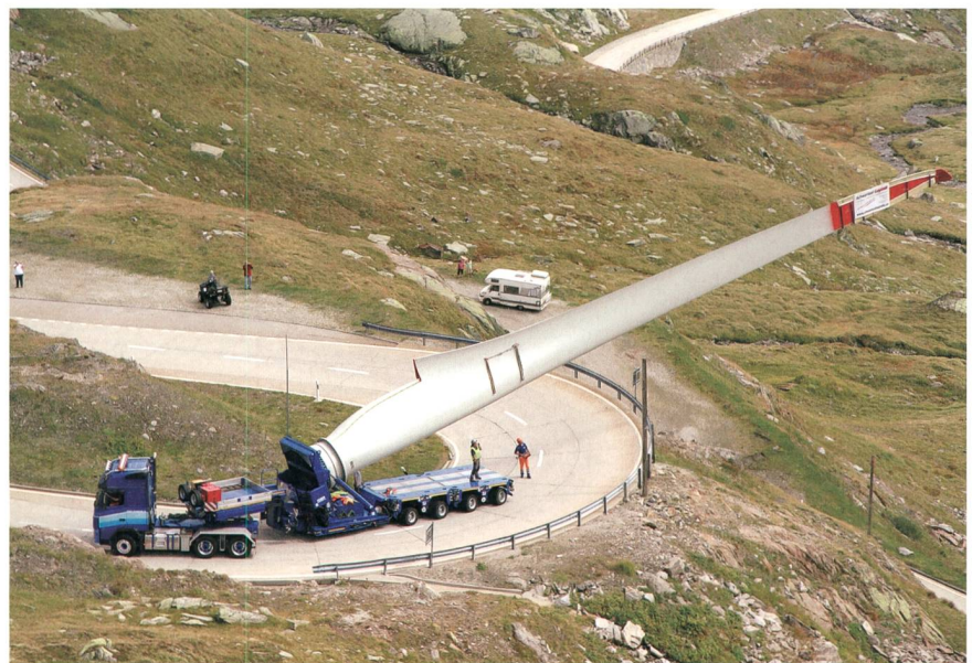
Bild 2 Transport eines Rotorblattes zur europaweit höchstgelegenen Windkraftanlage bei Ulrichen im Wallis. Je nach Bedarf kann das Rotorblatt entsprechend (bis zur Senkrechten) angehoben werden.
