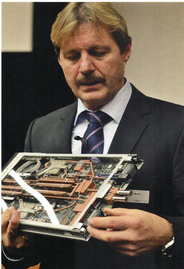
Bruno Michel erläutert, wie mit wassergekühlten Rechnern (hier ein Blade des an der ETH installierten Aquasars) die Wärme vom Feind zum Freund mutiert.
