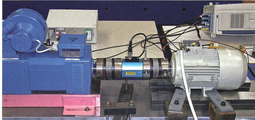
Bild 2 Versuchsaufbau zur Erprobung des Funktionsmusters mit der Lastmaschine (links), dem Prüfling und der dazwischenliegenden Drehmomentmesswelle.
