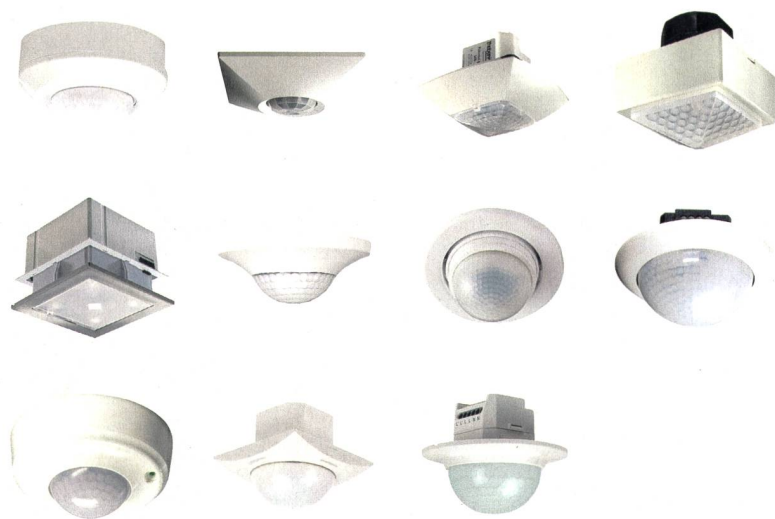
Bild 1 Die getesteten Präsenzmelder. Für das Messprojekt wurden 11 häufig eingesetzte Präsenzmelder, die hauptsächlich in Zweckbauten verwendet werden, evaluiert. Es handelte sich um Produkte der Firmen ThebenHTS, Swisslux, Züblin, Feller, Elbro, Merten und Steinel. Die PIRs wurden nicht direkt von den Händlern bezogen, sondern anonym im Handel gekauft, damit keine «präparierten» Produkte in den Test gelangen konnten.
