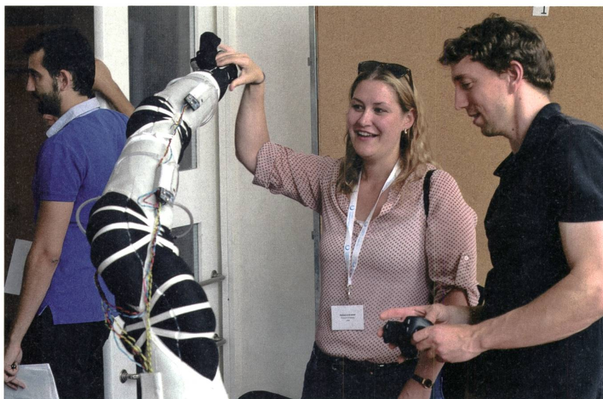
Ein aufblasbarer Roboter von Kevin Albert, OtherLab, USA. Soft Robots sind Roboter, die für Menschen ungefährlich sind, bei denen man sogar vor einem Händedruck keine Angst haben muss.
