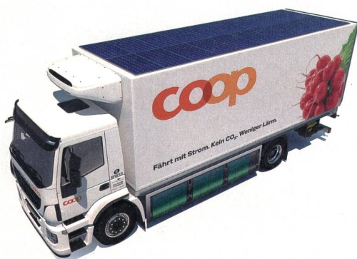
Das Kühlaggregat des E-Force wird über Solarmodule auf dem Dach des E-LKW gespiesen.
