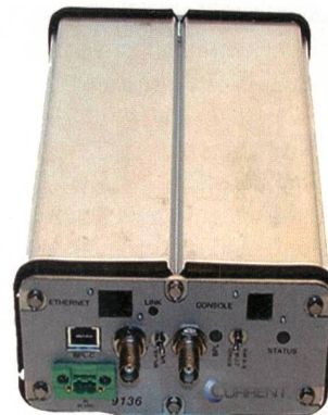
Bild 5 Ormazabal API-2000-SA MV-BPL Modem.
