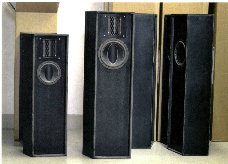
Bild 1 Bipol-Standlautsprecher von Rowen ohne Stoffbespannung. Oben sieht man den für den Hoch- und Mitteltonbereich zuständigen Linear Motion Transformer, darunter den Basstreiber.
