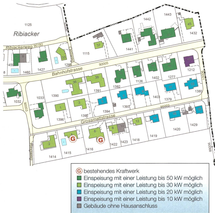
Bild 2 Eine einfache Darstellung zeigt auf, an welchen Hausanschlüssen wie viel Leistung eingespeist werden kann, ohne Grenzwerte der Leitungs- und Trafobelastung oder Spannungsanhebung zu überschreiten. Bestehende Einspeisungen sind mit einem Generatorsymbol abgebildet.
