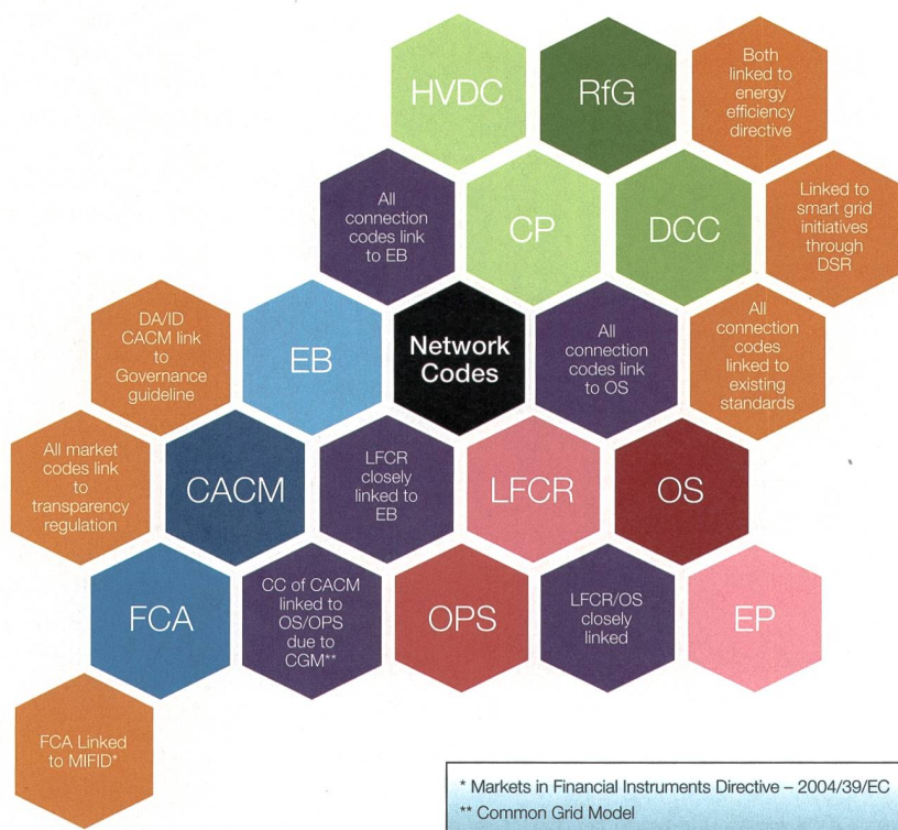
Bild 9 Schnittstellen zwischen den aktuellen Codes.
