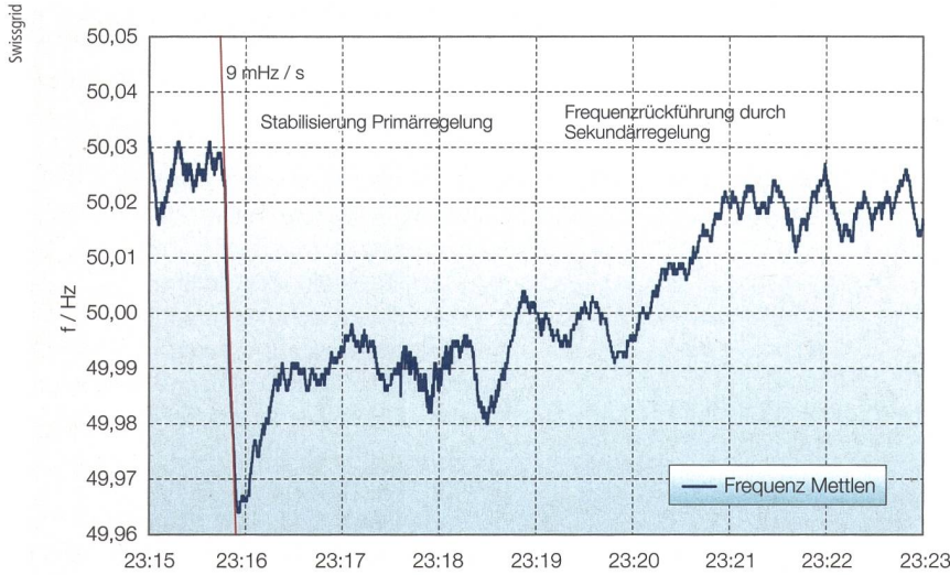
Bild 2 Ausfall eines Kraftwerks (1482 MW) im kontinentaleuropäischen Netz, August 2012.
