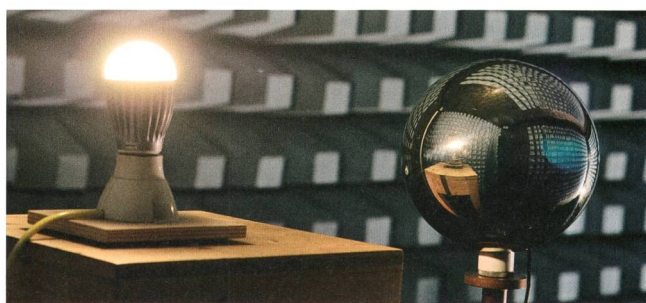
Bild 8 Messung der elektromagn. Felder einer Retrofit-LED.
