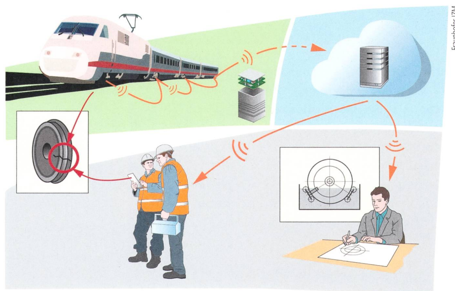
Cloud-gestütztes Sensornetzwerk zur zustandsbasierten Instandhaltung von Schienenfahrzeugen.
