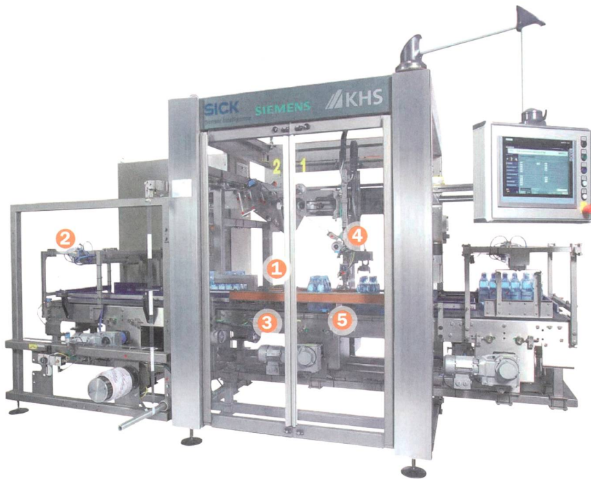
Bild 2 Anlage zum Anbringen eines Tragegriffs an unterschiedliche Sixpack-Gebinde mit intelligenten Sensoren.
