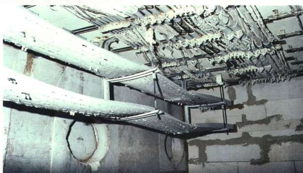
Figure 4 Avant (en haut) et après un essai. Seul le contrôle du maintien de fonction permet de vérifier la fonctionnalité en cas d'incendie.
