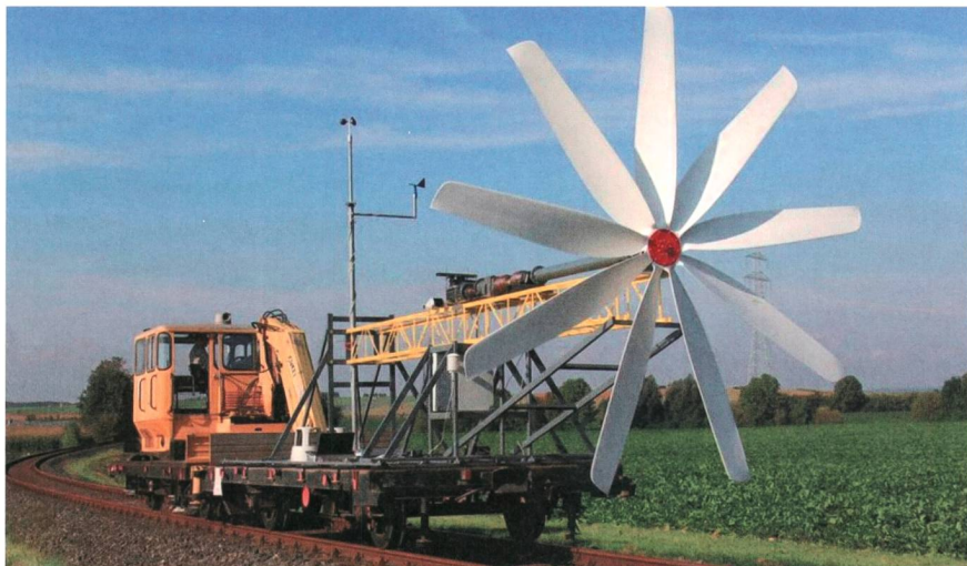
Un wagon ferroviaire au lieu d'une onéreuse soufflerie: test d'efficacité d'une nouvelle petite éolienne.
