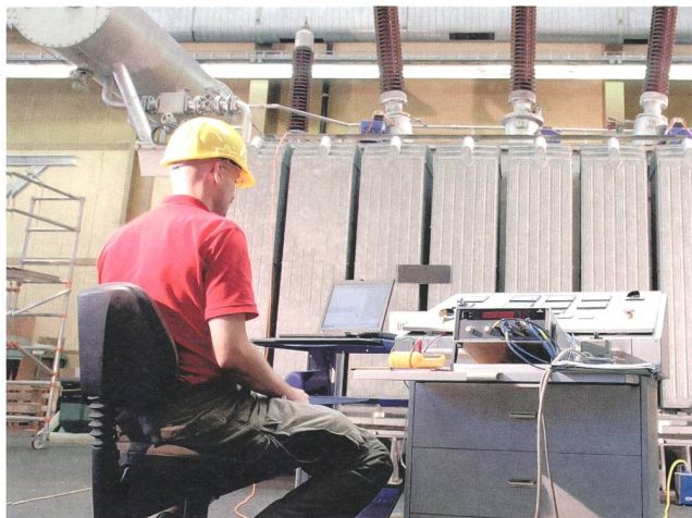
Bild 1 Beispielapplikation: Teilentladungsdiagnose am Transformator.
