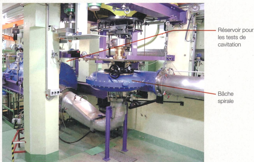
Figure 7 Turbine Diagonale à double réglage avec bête spirale sur le stand d'essais.
