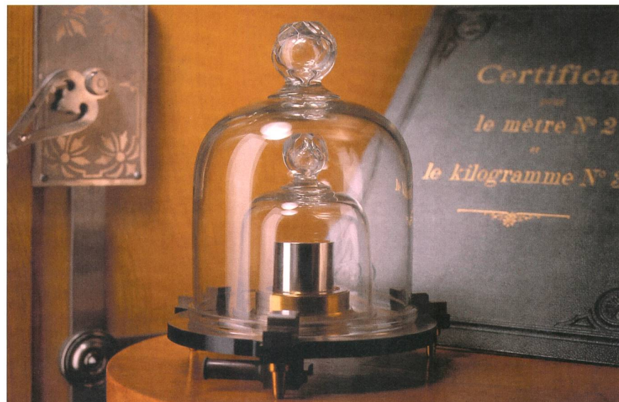
Figure 1 Le prototype national suisse du kilogramme est conservé à l'Institut fédéral de métrologie Metas.
