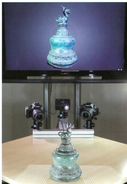
Typischer Aufbau mit der hochwertigen Scantechnologie von 3Digify.
