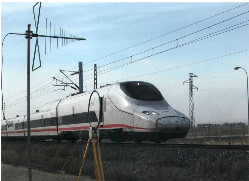
Figure 4 Mesures des émissions rayonnées d'un train Talgo.
