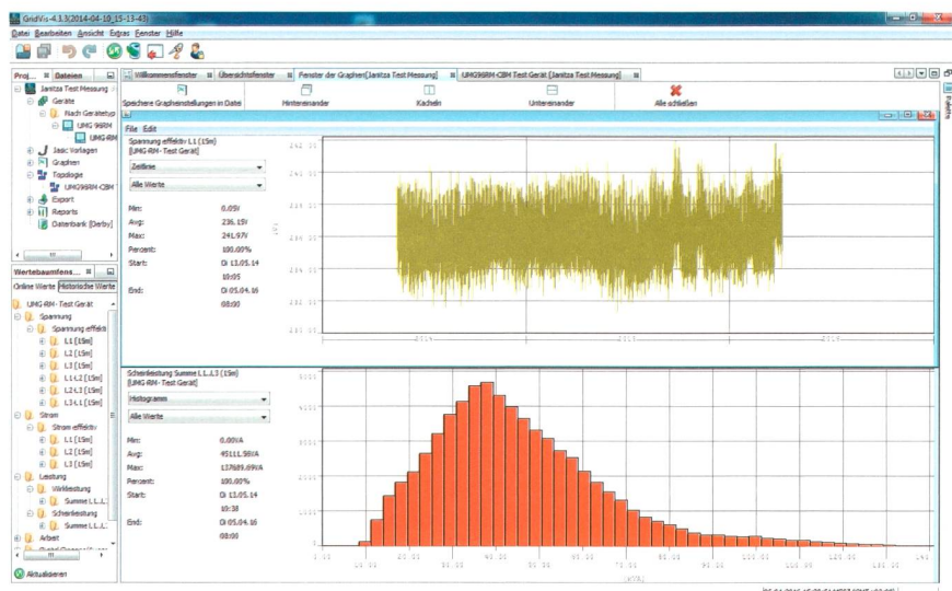
Bild 3 Mit dem Universalmessgerät in der Niederspannungs-Verteilung (NSV) kann der Lastgang des Transformators (Kategorie 2) ausgewertet werden.
