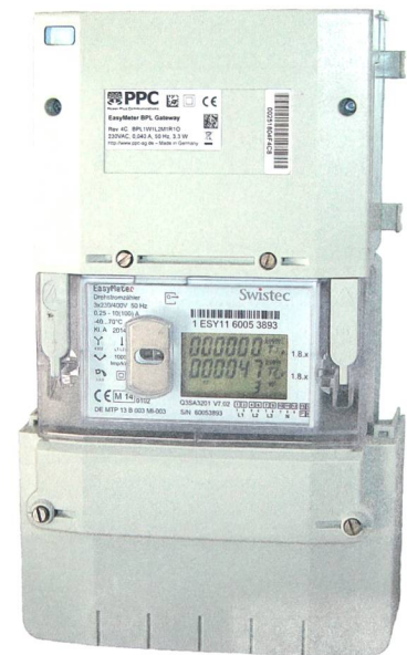
Der in der Gemeinde Rhäzüns eingesetzte Zähler mit BPL-Gateway.
