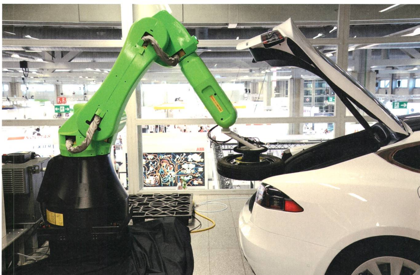
Kollaborative Roboter – Roboter, die in der Produktion direkt neben Menschen arbeiten können – gewinnen an Bedeutung. Dieser Roboter von Fanuc kann bis zu 35 kg präzise platzieren.
