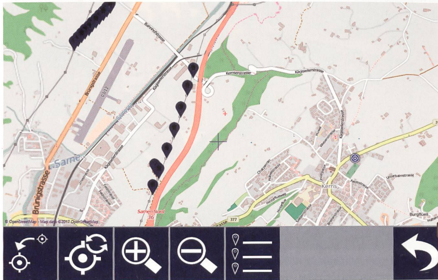
Bild 5 Auf einer Karte zeigt das System an, welche Verteilanlagen (Tragwerke) sich in der Nähe des aktuellen Standorts befinden.
