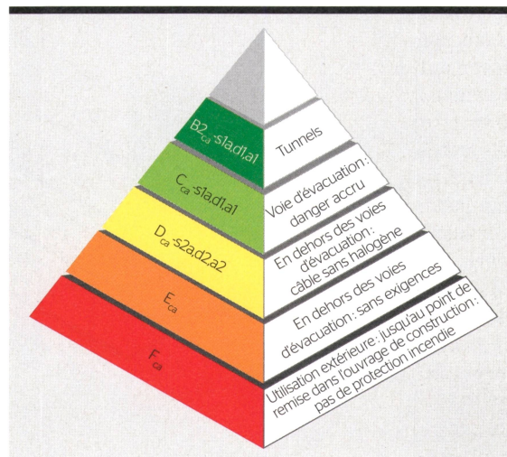
Figure 2 Classes de réaction au feu recommandées par le groupe de travail « CPR-Cable ».
