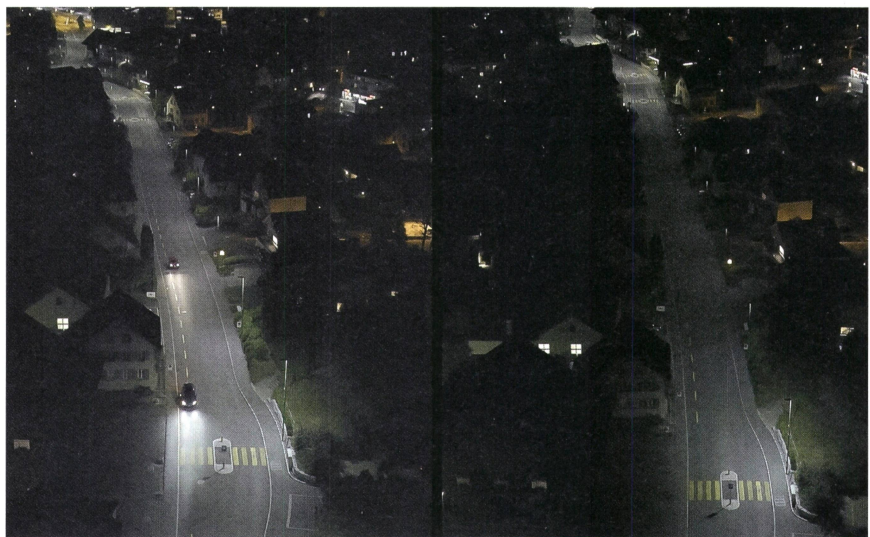
Birmensdorferstrasse in Urdorf – links mit 100 % Lichtstärke, rechts mit reduzierter Lichtstärke (40 %).
