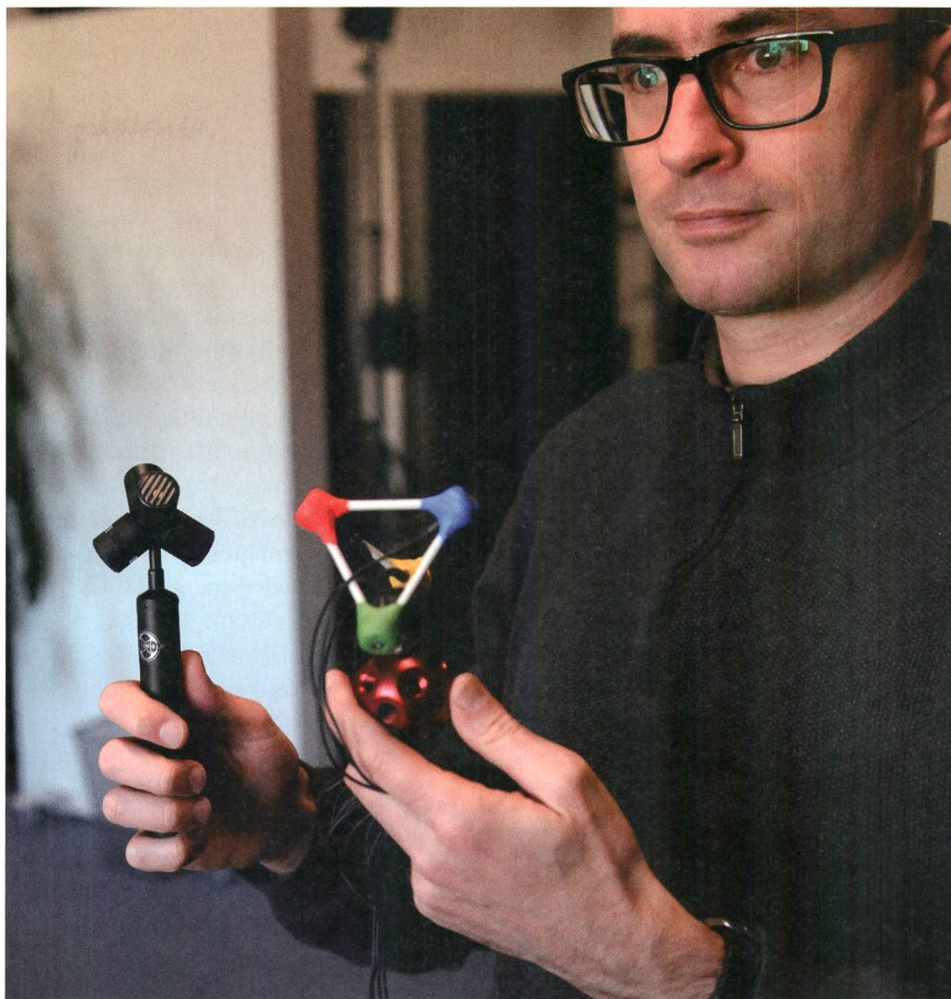
Bild 5 Christof Faller mit einem professionellen Virtual-Reality-Mikrofon für über 2000 Fr. (links) und der Illusonic-Lösung mit vier Kugelmikrofonen für rund 10 Fr.
