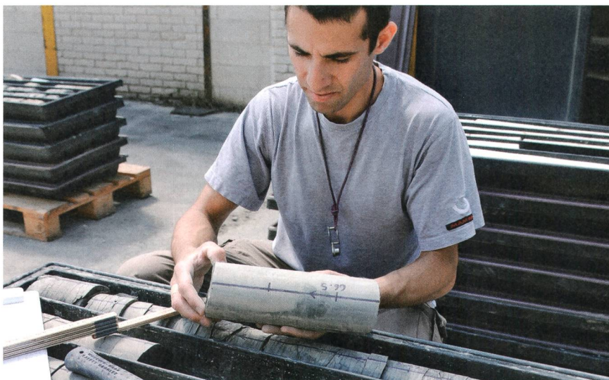
Ein Geowissenschaftler vermisst und dokumentiert einen frisch gezogenen Bohrkern auf dem Bohrplatz.
