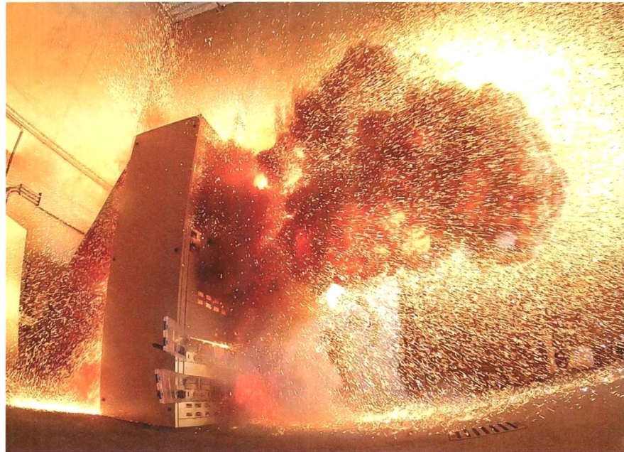
Störlichtbogenprüfung ohne Schutzmassnahmen.
