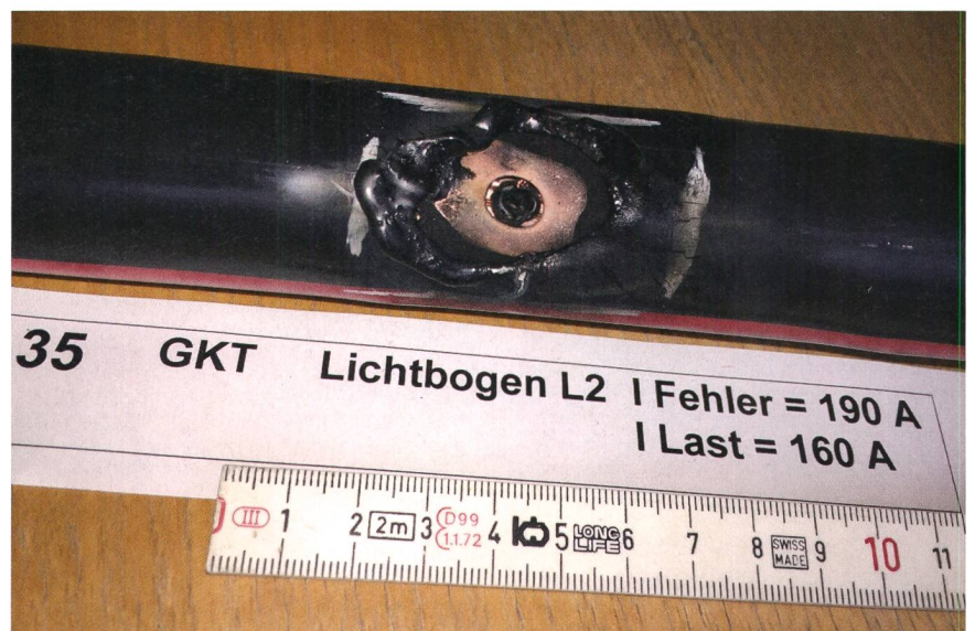
Bild 3 Fehlerstelle eines durch den Erdschluss beschädigten Versuchskabels.
