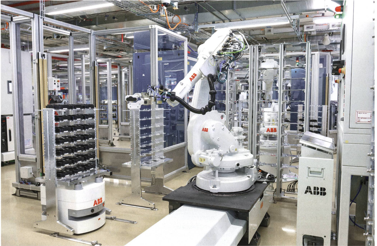
Eine Roboterzelle wird mittels eines AGV mit einem Halbleitermodulloos beschickt.
