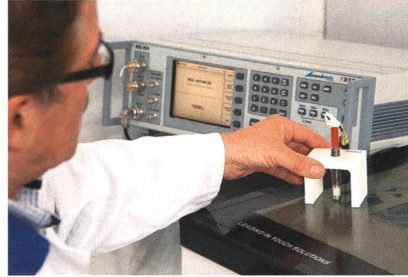
EMF-Prüfaufbau für Touchpanels.
