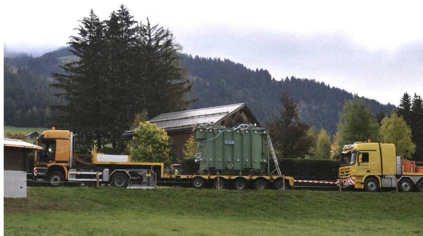
Bild 4 Transport eines Trafos in Saanen (BKW).
