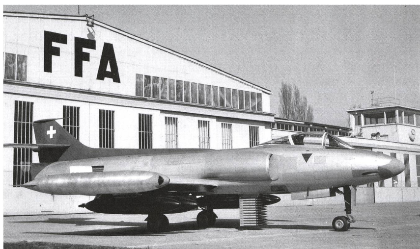
Bild 1 Schweizer Strahlflugzeug P-16. Für dieses von den Flug- und Fahrzeugwerken Altenrhein SG entwickelte Düsenflugzeug wurden mit der Zuse Z4 zwischen 1953 und 1955 Flatterrechnungen und Berechnungen zum Sturzflug durchgeführt.
