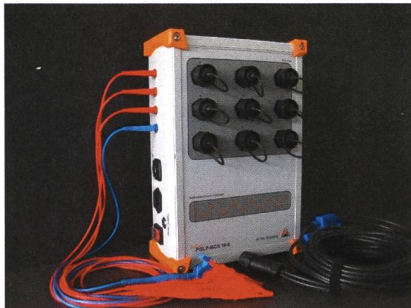
Die PQLP-Box kommuniziert via Ethernet.
