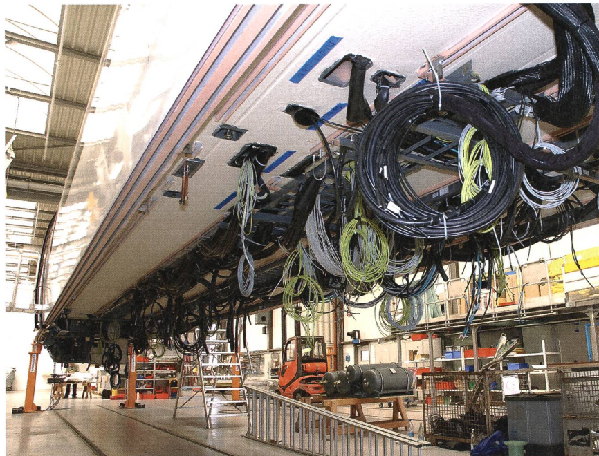
Bild 4 Kabelmenge in einem Zug.
