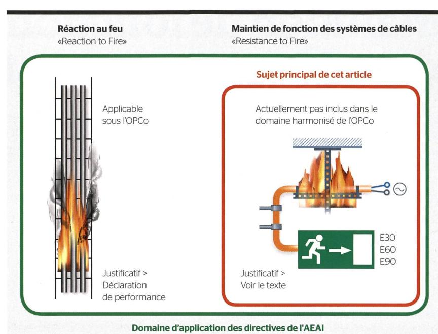
**Figure 1** À gauche les propriétés incendie « réaction au feu », à droite le maintien de fonction (« résistance au feu »), dans lequel le système de câbles doit continuer à fonctionner en cas d'incendie et, en vert, domaine d'application des directives de l'AEAI.
