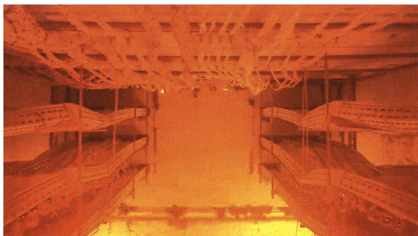
Test secondo DIN 4102-12: i cavi e i sistemi di fissaggio vengono testati fino a 90 minuti in condizioni simili alla realtà a temperature fino a oltre 1000 °C.
