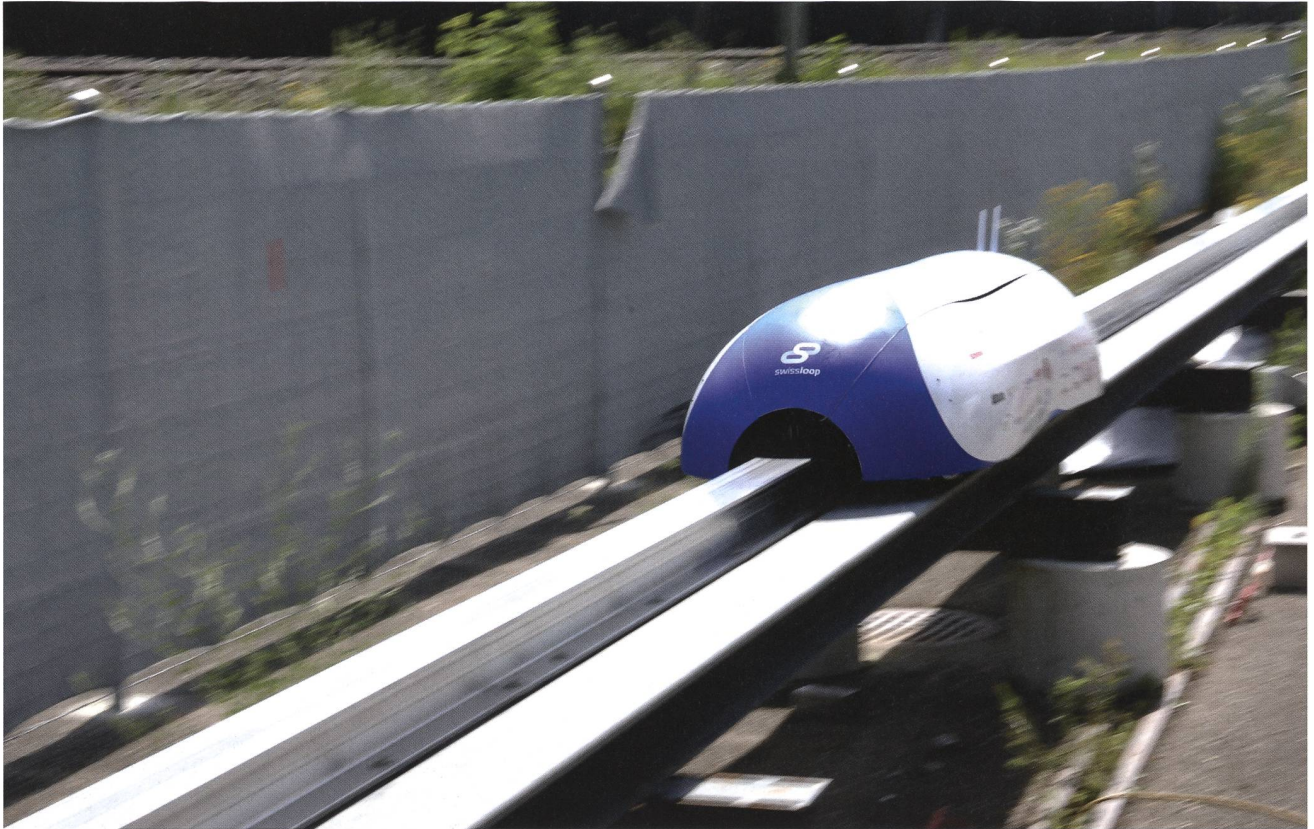
Auf der Teststrecke der Empa in Dübendorf schwebt der Pod lautlos mit 50 km/h dahin.
