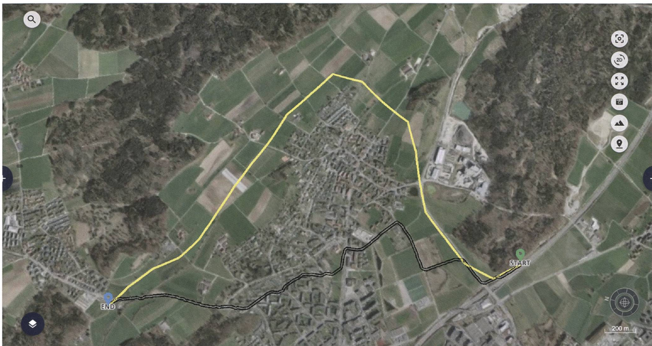
Vergleich zweier 110-kV-Leitungen (gelb = Freileitung; schwarz = Erdkabel).
