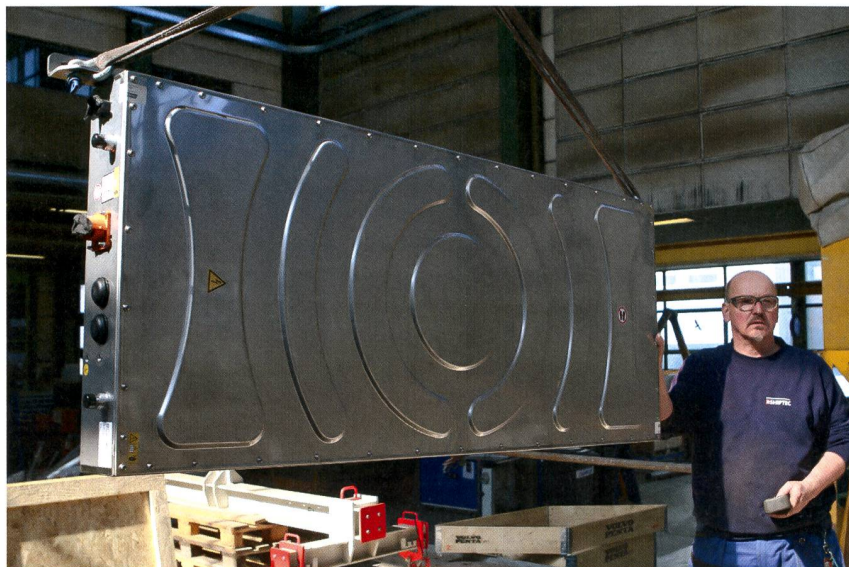
Eine der drei Akazem-Batterien mit 33 kWh Kapazität.
