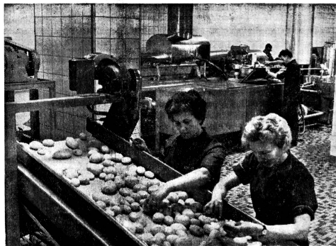
Die automatisch geschälten Kartoffeln werden vor dem Waschen und Schneiden sorgfältig geprüft. Nur die besten sind gut genug.
