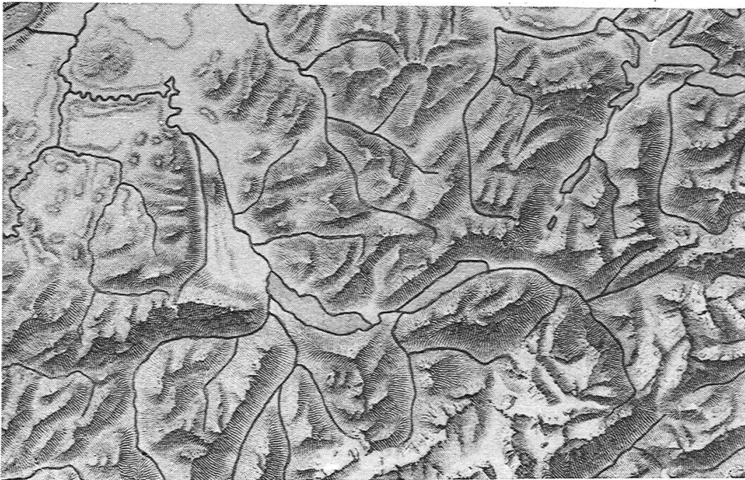
Abb. 11. Ausschnitt aus der Uebersichtskarte der Schweiz im Masstab 1:1,000,000 von R. Leuzinger; vertikale Geländeschraffen.
