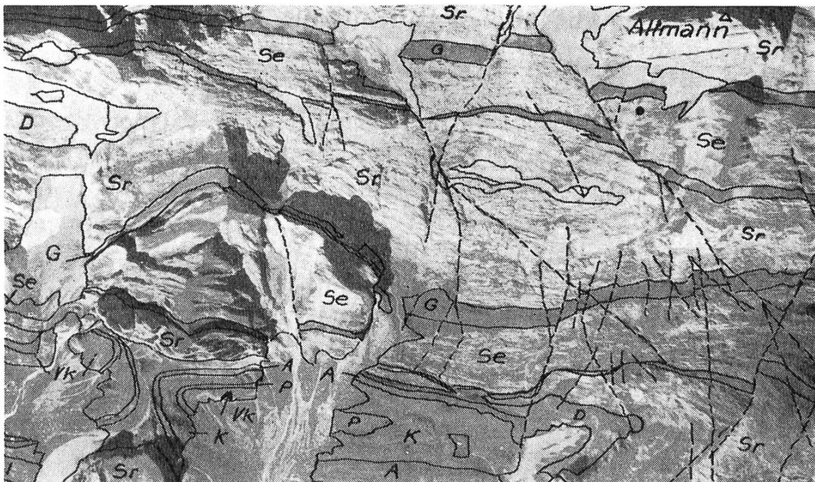
Fig. 24. Geologische Photokartierung. Senkrechtaufnahme mit eingetragenen Resultaten der geologischen Feldarbeit (Aufnahme der Eidg. Vermessungsdirektion).
