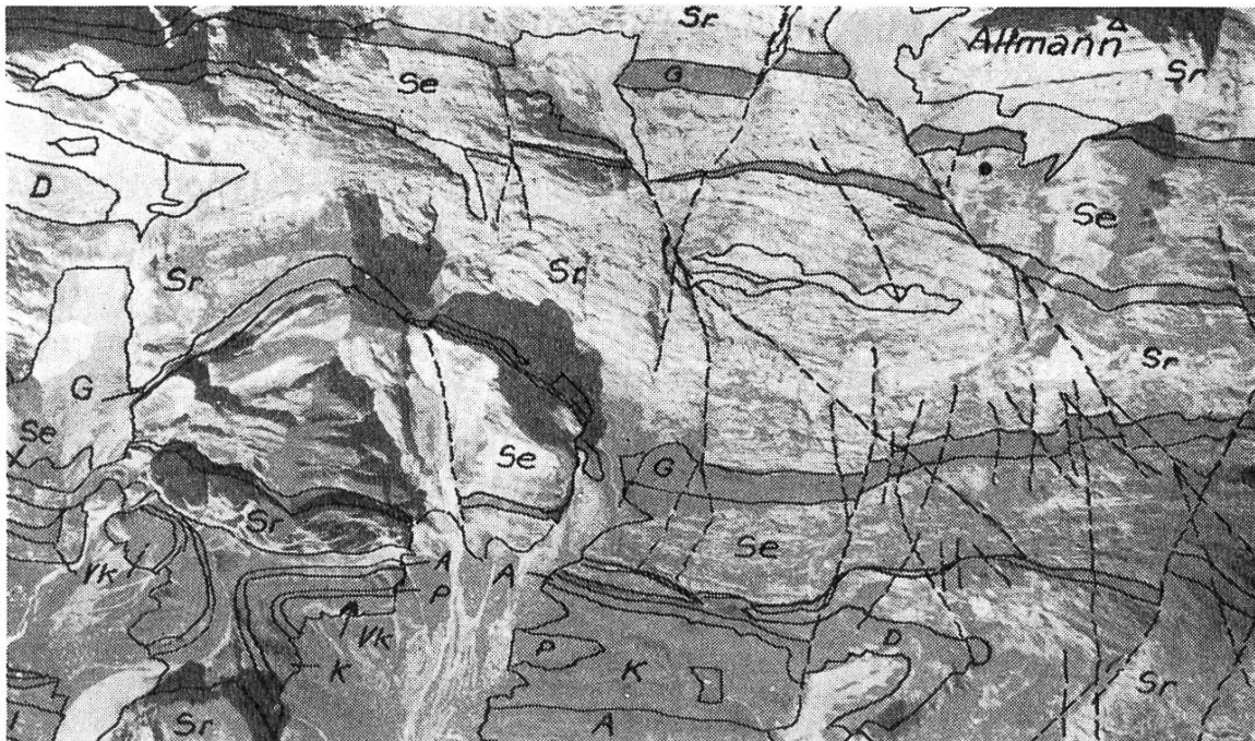
Fig. 24. Geologische Photokartierung. Senkrechtaufnahme mit eingetragenen Resultaten der geologischen Feldarbeit (Aufnahme der Eidg. Vermessungsdirektion).
