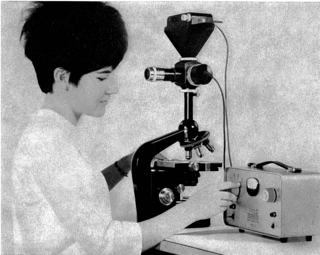
Abb. 7 Mikroskop Wild M20 mit Mikro-Photo-Automatik MKa 4, automatischer Kleinbildkassette und Steuergerät.
