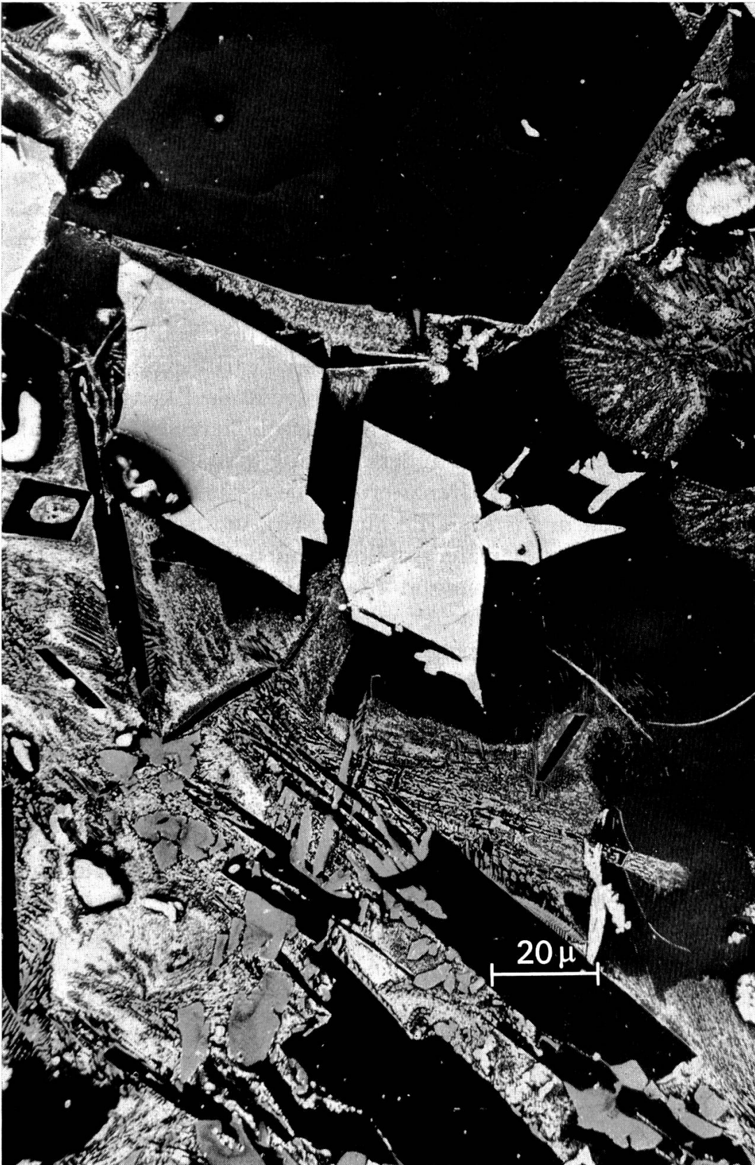
Abb. 16 Photoemissionsbild eines Basalt-Anschliffes mit klarer Unterscheidbarkeit der verschiedenen Gesteinskomponenten im Materialkontrast. Vergrößerung 760 \times .
