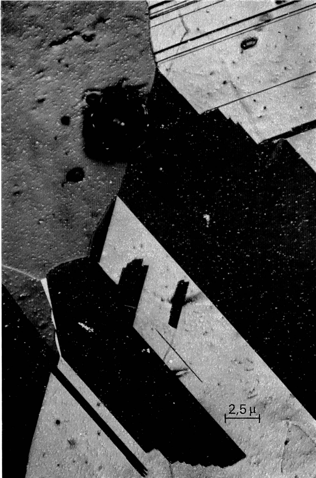
Abb. 9 Photoemissionsaufnahme einer Kupferoberfläche. Das Objekt wurde im Mikroskop bei 800^{\circ}\text{C} rekristallisiert und nach Abkühlung auf 200^{\circ}\text{C} aufgenommen. Vergrößerung 4800\times .
