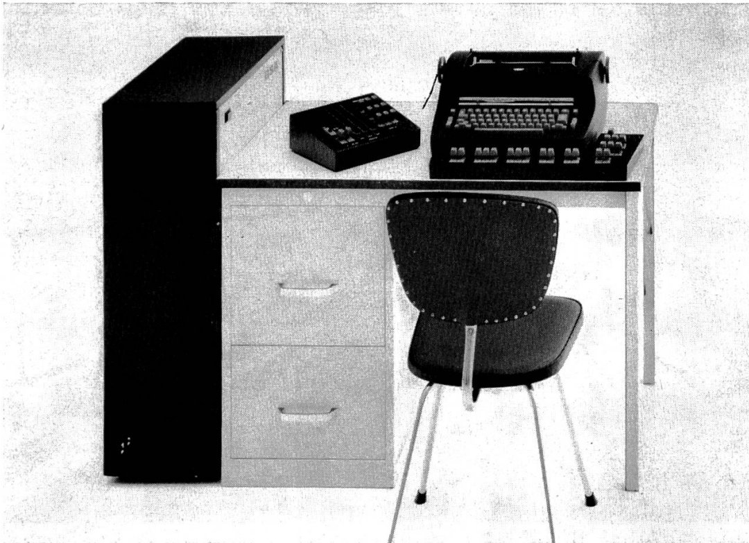
Bild 11 Satzlocher des GSA-Systems mit zusätzlichem Tastenschuh und Zeilennumerierungszusatz. In der Schublade ist der Lochstreifenstanzer untergebracht; im Kasten links befindet sich die Elektronik.
