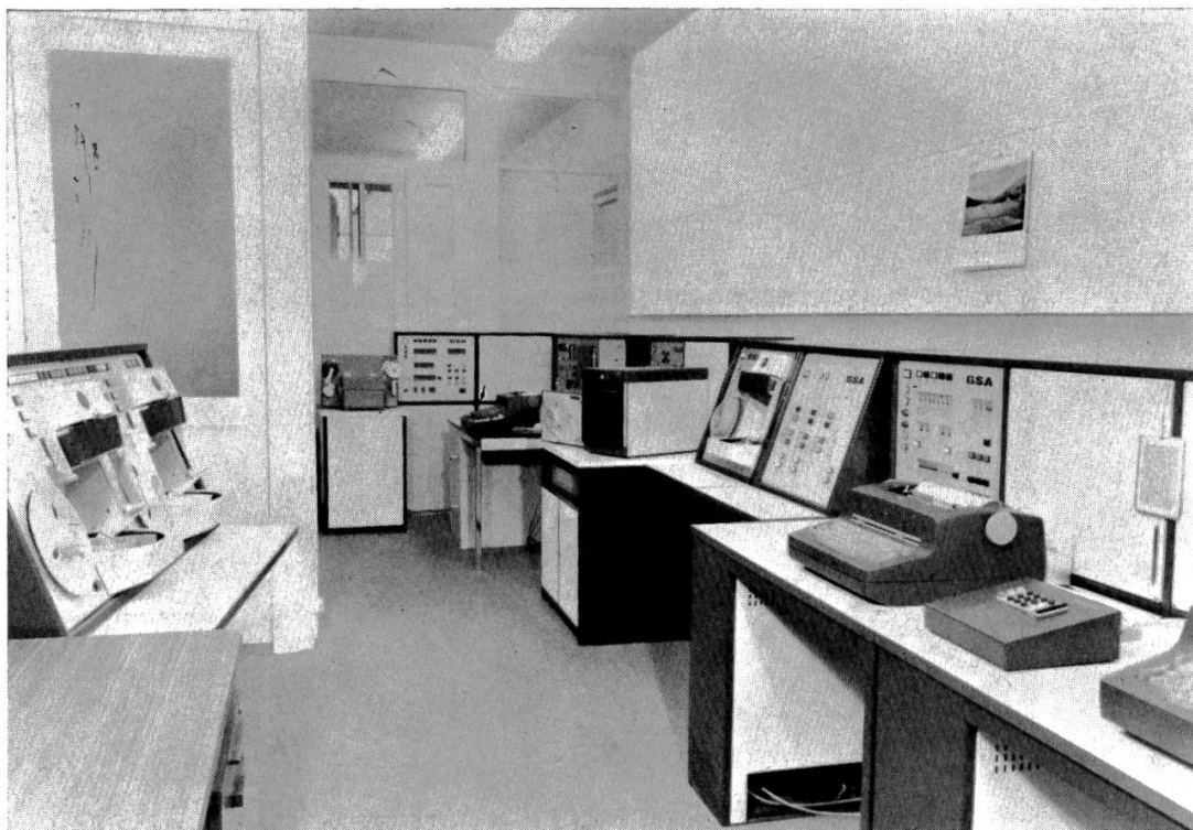
Bild 12 Gesamtansicht einer GSA-Anlage für «Monotype» Satz und Zeilensatz, ohne Satzlocher. Im Hintergrund Monapter und Monotron für den «Monotype» Satz, daran anschließend die Silbentrennstation. In der Mitte rechts ein Lochstreifenleser und ein Umschaltpult. Rechts im Vordergrund die Zeilenausschließstation für den Zeilensatz, davor zwei Druckstationen. Links vorne die Korrekturstation. (GSA bedeutet Güttinger-Satz-Automation.)
