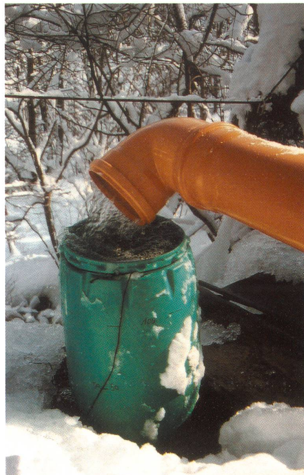
Abbildung 6: Wassererfassung mit dem Fass am Portal des Wolfslochsstollens.
