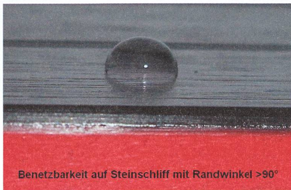
Abbildung 4: Die geringe Benetzbarkeit einer ca. 3 Mikrometer dünnen Schicht von E-Indigo auf einer Skioberfläche mit Steinschliff, nachgewiesen mit der Form eines Wassertropfens. Je kugelförmiger der Tropfen, je grösser der Randwinkel des Tropfens zur Oberfläche, desto geringer ist die Benetzbarkeit. Foto: Peter Bützer.
