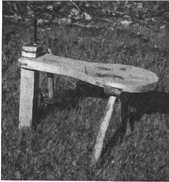
Abb. 2: Cavorgia, Gemeinde Sedrun (Vorderrheintal) Dengelstuhl, dreibeinig, wobei die vordere, stärkere Stütze gleichzeitig als Dengelholz dient. Damit es nicht gesprengt wird, ist es mit Draht umwunden. Am Dengeleisen hängt der Dengelhammer.
